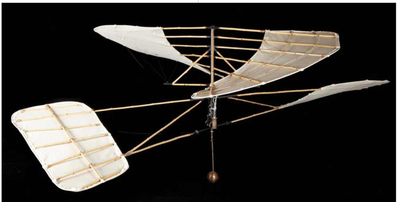
Enrico Forlanini's experimental helicopter of 1877. (Museo Nazionale della Scienza e della Tecnologia Leonardo da Vinci, Milan).
